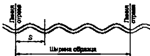
Рисунок 19 — Схема обрезки целых листов перед испытанием
