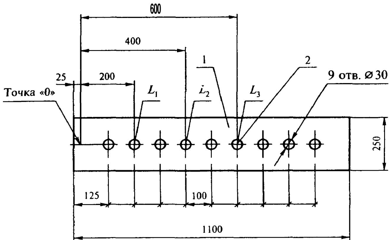
*1 — калибровочный образец, 2 — отверстия для измерителя теплового потока*
